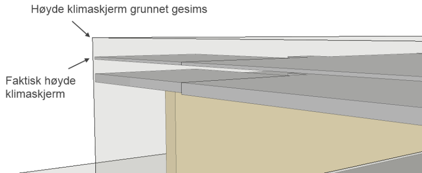
Figur 4.12 Høyde på klimaskjerm i IDA ICE etter import av IFC modell med gesims.
